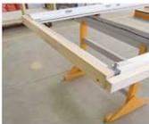
[3] Mit Spachtel jene Füllleiste(n) vorsichtig demontieren, unten denen verschraubt wird – siehe Bild 2. Dazu die Schließteile als Widerlager verwenden.
